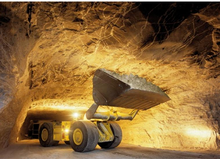
*Una volta disgregato dalle esplosioni, il sale grezzo viene rimosso e trasportato con enormi macchinari con capacità di carico fino a 20 tonnellate. (Fonte: K+S KALI GmbH)*
